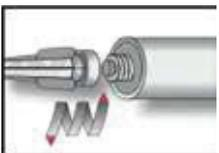
6. Antes de utilizar el producto, asegurese que la mezcla sea homogénea. Aplique un cordón de 10 cm de largo en un lugar que no comprometa el anclaje, observando que la coloración de la mezcla de ambos componentes sea de color gris. Sólo después de que ocurra la mezcla rellene los orificios con el anclaje químico. Nunca utilice el producto si la mezcla no es homogénea.
