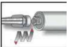
5. Antes de utilizar el producto, asegurese que la mezcla sea homogénea. Aplique un cordón de 10 cm de largo en un lugar que no comprometa el anclaje, observando que la coloración de la mezcla de ambos componentes sea de color gris. Sólo después de que ocurra la mezcla rellene los orificios con el anclaje químico. Nunca utilice el producto si la mezcla no es homogénea.
