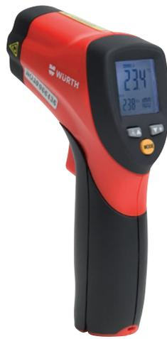
**Para la medición de temperatura sin necesidad de contacto, mediante puntero láser integrado.**
