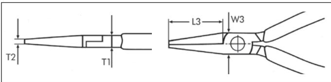
**Para agarrar, sujetar y cortar alambres y cables duros y blandos.**
